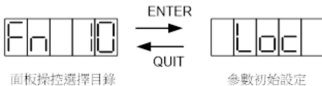
“參數初始設定”會將CSBL750所有系統參數重設成出廠時的預設值。一旦執行就不易回復，為防止使用者在不注意的情況下誤用此功能，CSBL750有多一道防護機制。使用者必須先以**FN 10**功能解除系統閉鎖狀態，才能執行本功能。
