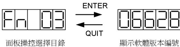
在“面板操控選擇目錄”顯示“**FN 03**”時按下**ENTER**鍵，即可進入“顯示軟體版本編號”功能（顯示畫面如左）。
