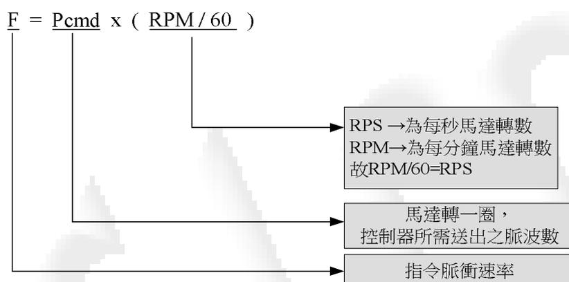
範例 A：若編碼器規格為（解析度 2500P/R）參數 PN12、PN13 設定為 1 時，要使馬達轉速到達 3000RPM，則控制器所需送出指令脈衝速率為何？
