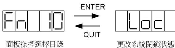
在“面板操控選擇目錄”顯示“**FN 10**”時按下**ENTER**鍵，即可進入“更改系統閉鎖狀態”功能。此時CSBL750會將系統目前閉鎖狀態，“Loc”或“UnLoc”顯示在LED上（顯示畫面如左）。
