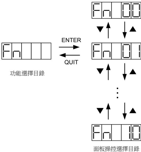
面板操控功能是讓使用者在進行系統微調或馬達測試時，能夠透過面板操作，即可完成所有必要的動作。各種操控功能的詳細內容及操作，請參考附表。
