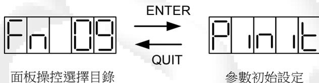
若在按下**ENTER**鍵時，系統已先解除閉鎖狀態，CSBL750即會執行“參數初始設定”，將所有系統參數重設成出廠時的預設值，並在LED上顯示“Pinit”（顯示畫面如左）。
