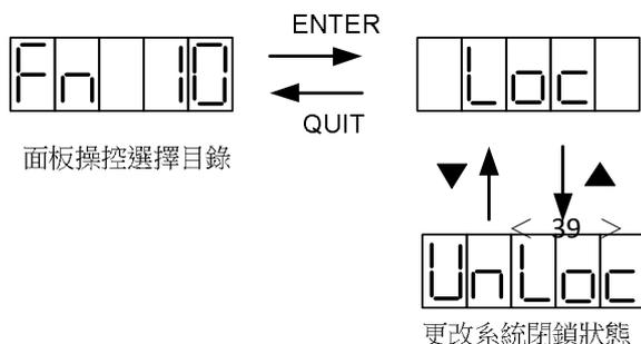
使用者可藉▼▲鍵來更改閉鎖”Loc”或解除閉鎖”UnLoc”，再按ENTER鍵確認即可完成更改，回到”面板操控選擇目錄”。
