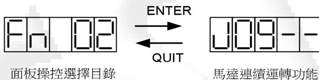
”馬達連續運轉”功能提供使用者不外接任何控制器，在CSBL750面板上即可控制馬達正反旋轉的能力。
