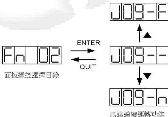
在執行”馬達連續運轉”時，馬達的轉速是由系統參數**”VJ”**設定（參數編號為**PN14**）。馬達啟動後的加轉速及停止時的減速度是由系統參數**”VA”**設定（參數編號為**PN11**，各系統參數的說明請參閱附表）。使用者可用前面”系統參數設定目錄”所述程式變更這些參數。
